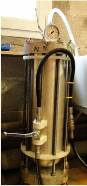
Les essais sont réalisés dans un caisson d'épreuve en aluminium rempli d'eau, mis en pression par une pompe manuelle pouvant monter à 50 bars. ( soit une profondeur d'immersion simulée d'environ 500m )
