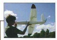
MODELL-FLIEGER Wissenschaftler der University of Southampton haben dieses Elektroflugzeug entworfen, das aus fünf aus Kunststoff gedruckten Bauteilen besteht
