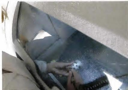
**Un souffle d'air.** Pour finir le nettoyage, l'objet imprimé est soumis à un puissant souffle d'air comprimé.
