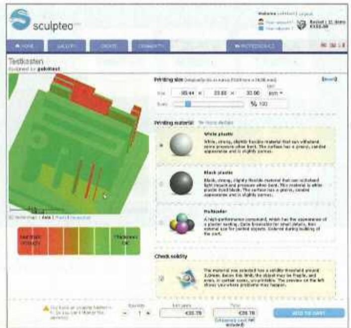
Die Vorschau von Sculpteo hebt zu dünne Stellen einer 3D-Vorlage rot hervor – hier wird vor den 0,2 und 0,5 Millimeter dünnen Plättchen und Stangen unseres Testkastens gewarnt.
