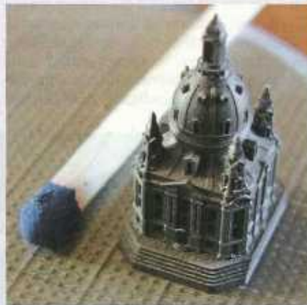
Eine Maschine des Herstellers EOS produzierte diese Miniatur der Dresdner Frauenkirche im Lasersinterverfahren.
