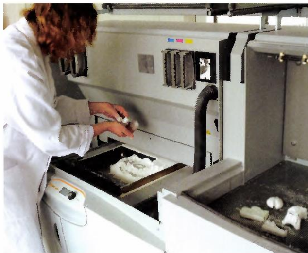
1 L'imprimante 3D de Sculpteo superpose des couches de matière de 0,1 millimètre.
